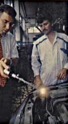
Teknik endoskopun halojen lambasının 12 volt olması, elektrik sarfiyatının çakmaktan alınmasını sağlıyor.
